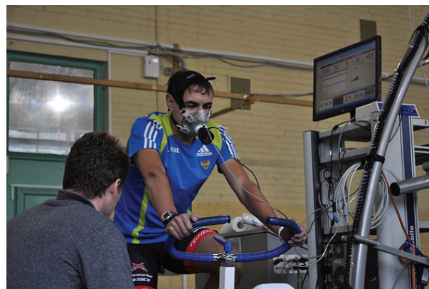
Рис. 1. Процедура выполнения тестирования с использованием газоанализатора и регистрации кардиоинтервалов ритма сердца
